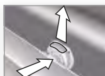
Supresión de la seguridad combinando el apoyo en el saliente y el movimiento del pestillo.
