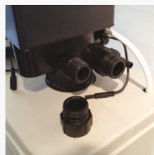
Colocar las roscas en la válvula.
