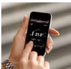
Control a distancia de un sistema de calefacción-refrigeración con regulación Vitotronic mediante conexión móvil a Internet.
